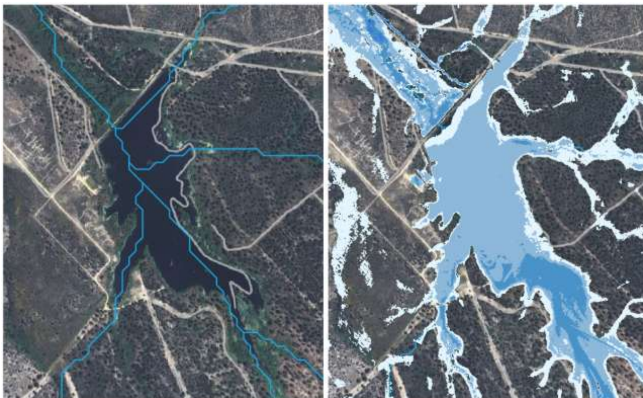
FIGURA 19 - INTERRUPÇÃO DA REDE DE DRENAGEM E SUPRESSÃO DA ÁREA DE RETENÇÃO NATURAL A SUL DA PLATAFORMA (SOLUÇÃO NASCENTE).
